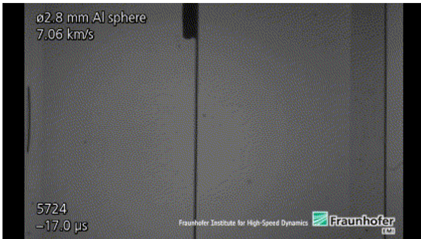
Figuur 1: Botsing van een 2,8 mm aluminium bol met hypersnelheid (Bron: Fraunhofer Institute for High-Speed Dynamics)
